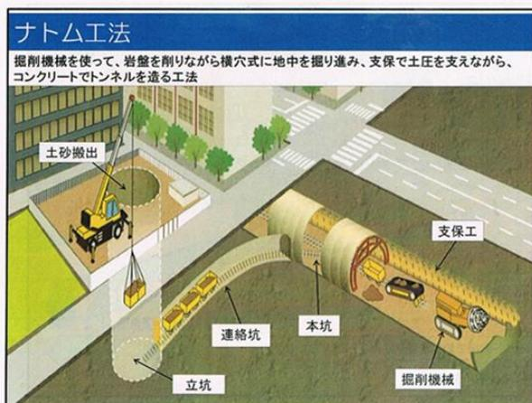
何故このような事故が起こったのでしょうか。原因究明は国立研究法人土木研究所に委ねられていますが、もともと工事の技術的検討は福岡市地下鉄七隈線建設技術専門委員会で行われており、「ナトム工法に対する懸念」と「ボーリングのデータから地盤に脆い部分があり得る」ことが事故前から指摘されてきました。ナトム工法で行うことは承認されましたが、トンネルの深さを1メートル下げるとともに「薬剤注入で地盤を補強すべき」と言われていました。しかし12月3日の西日本新聞の報道によると、鉄棒を倍にすることで補強し、薬剤注入による補強はなされなかったことが明らかになっています。
